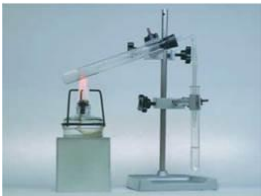
Мал. 21.2. Добування етанової кислоти в лабораторії
