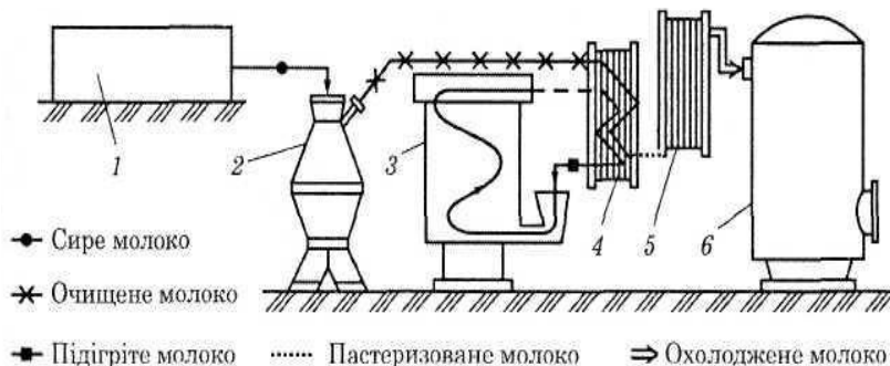
Рис. 15.1. Технологічна схема первинної обробки молока:
