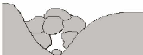
Figura 6: Esquema de uma caverna formada por blocos em canal.
