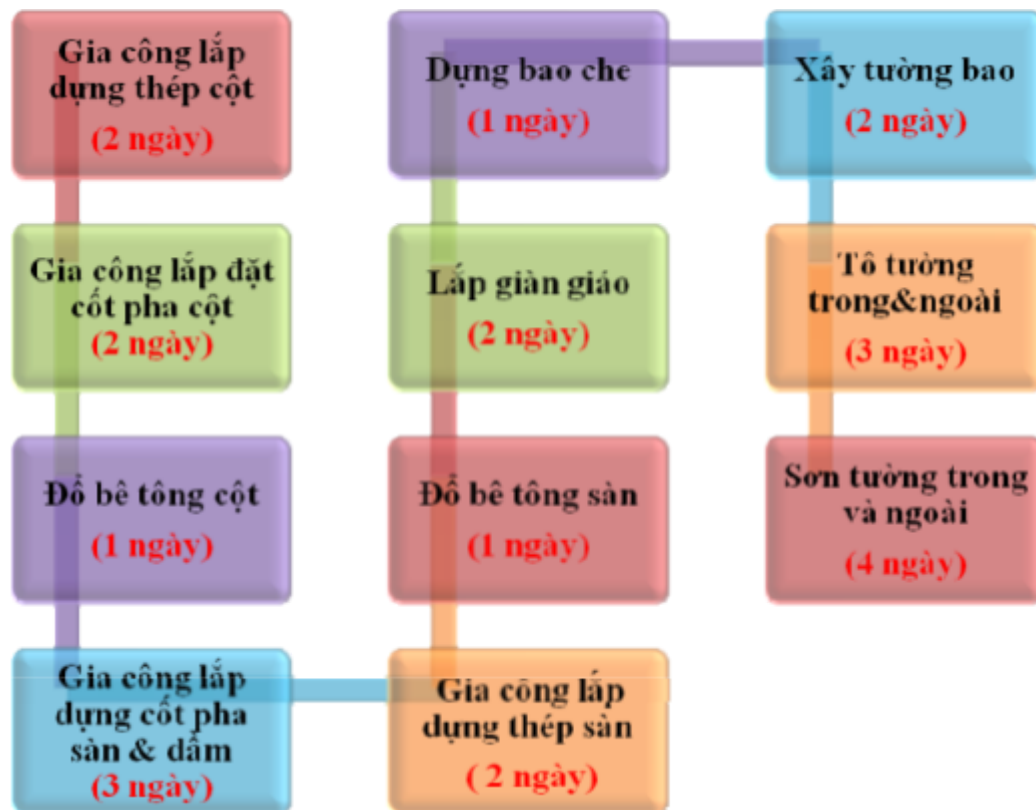
Hình 2.3 Quy trình thi công phần thô bằng biện pháp đổ bê tông tại chỗ
