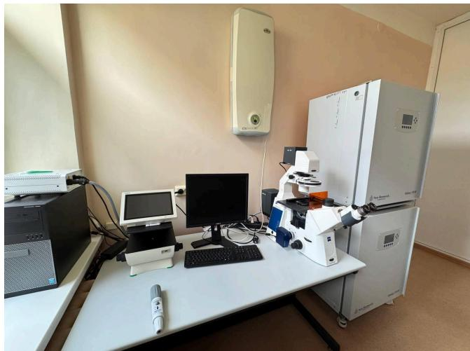
Микроскоп Axio Observer1 предназначен для исследования живых культур клеток, в том числе находящихся в лабораторной посуде; Устройство флуоресцентной визуализации клеток ZOE позволяет просматривать образцы, получать и сохранять
