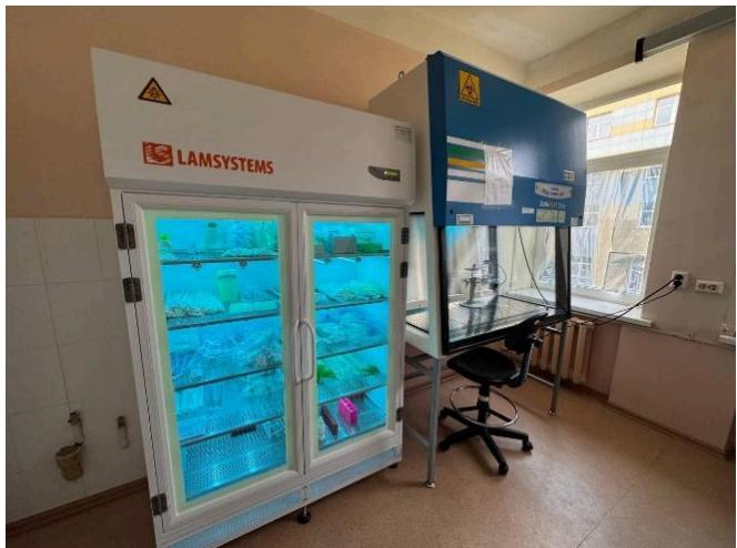
Лабораторный комплекс для работы с культурами клеток: ламинарный щкаф с вертикальным потоком воздуха SafeFast Elite 212S, боксы ламинарные MARS, инкубатор СО2 Galaxy СО 170R, щкаф стерильного хранения «Ламинарные системы», ультразвуковой термостатический медицинский морозильник MDF Sanyo и
