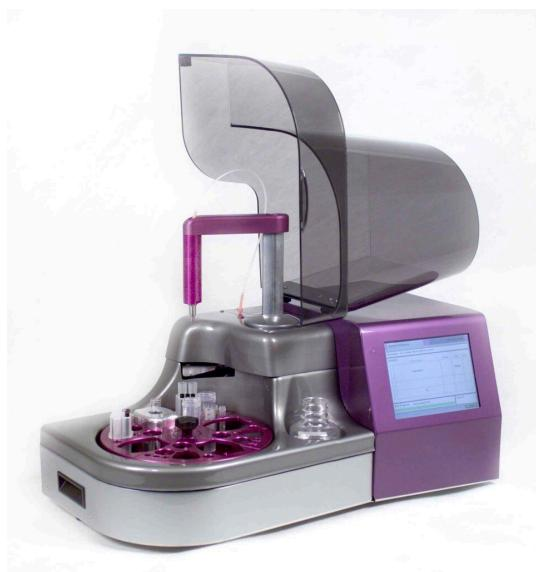
Автоматизированная система изоляции клеток Robosep, обеспечивающая одновременную изоляцию до 4 образцов или последовательную изоляцию до 4 типов клеток из одного образца.
