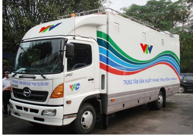
Hình 5: Xe truyền hình lưu động cỡ vừa 6 camera Sony BVP-E30P của Trung tâm Sản xuất Phim Truyền hình.
