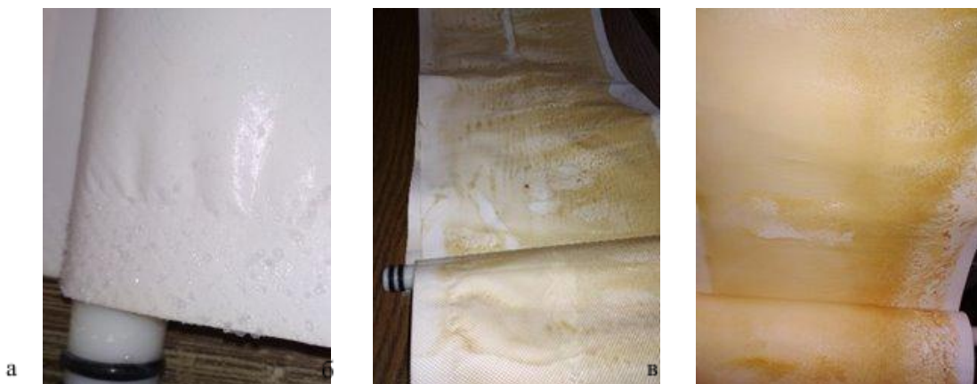
Рисунок 3.1 – Фото розкритих забруднених мембран: а – солями жорсткості; б – біофоулінгом; в – залізом
