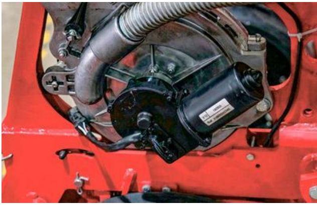
Рис.6.10. Монітор бортового комп'ютера (зліва) та електропривід висівного апарату (справа).
