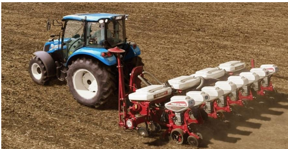
Рис.6.6.. Начіпна, восьмирядна просапна сівалка VEGA 8 PROFІ, з внесенням гранульованих мінеральних добрив,
