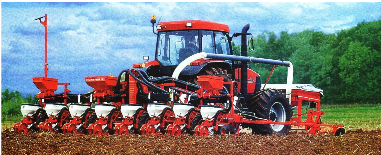
Рис.6.15. Вісьмирядна універсальна просапна сівалка PLANTER KUHN (Франція) з пристроєм для внесення мінеральних добрив та пристроєм для внесення гербіцидів
