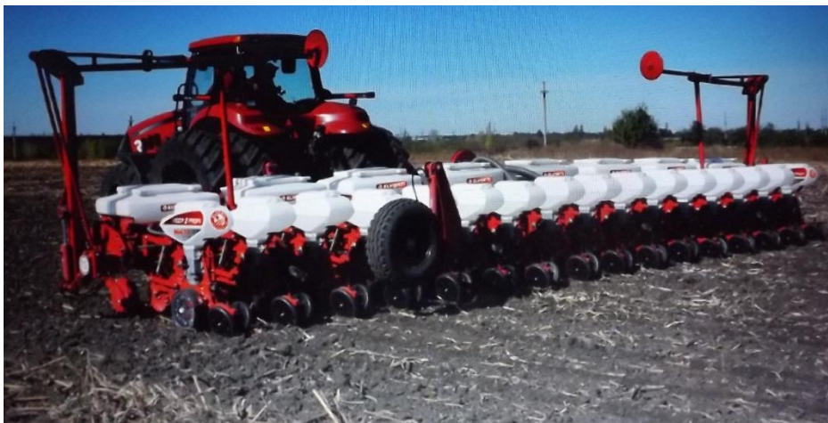
Рис.6.5.. Напівначіпна, шіснадцятирядна просапна сівалка VEGA 16 PROFІ, з внесенням гранульованих мінеральних добрив,
