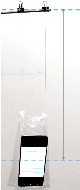
圖二、手機單擺。手機可放塑膠袋中，塑膠袋上緣兩端用兩條細線綁好，固定到橫桿上。兩細線平行，可擺動的長度應一致。
