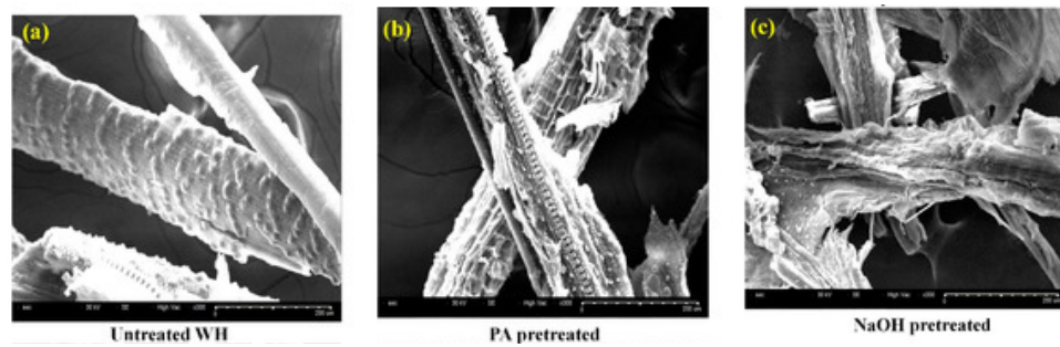
Gambar 9. Hasil Analisis SEM dari Eceng gondok
