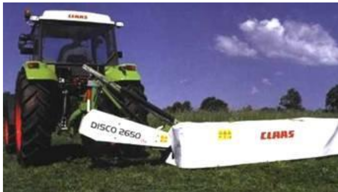
9. Косарка навісна DISCO 2650 (фірма Claas)
