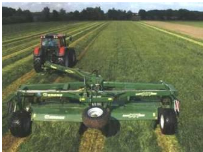
10. Косарка причіпна Eusy Cut 6200 (фірма KRONE)
