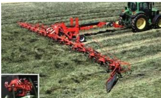
11. Ворущилка FG 17002 (фірма Kuhn)
