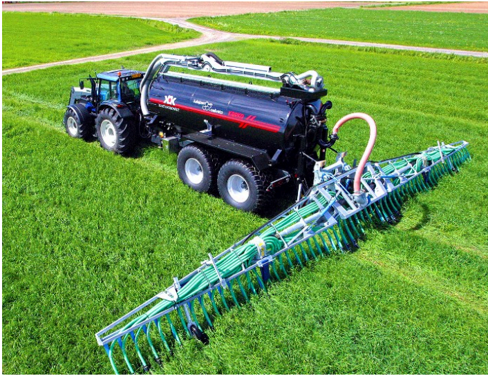
Рис.15. Машина для рівномірного поверхневого внесення гноївки (підживлення трави) зарубіжного виробництва.
