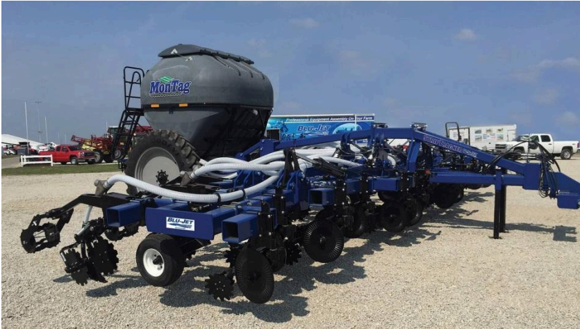
Рис.9. 12-ти рядна ґрунтообробна машина BLU-JET за технологією STRiP-TiLL з пристроєм для внесення мінеральних добрив MonTag.
