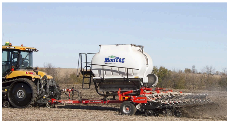
Рис.8. 16-ти рядна ґрунтообробна машина KUHN-KRAUSE GLADIATOR за технологією STRiP-TiLL з пристроєм для внесення мінеральних добрив MonTag.
