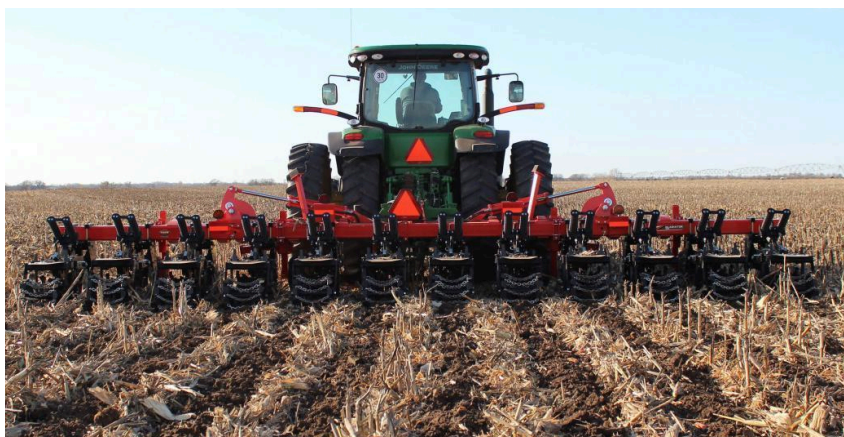
Рис.6. 12-ти рядна ґрунтообробна машина
