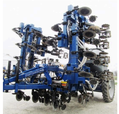
Рис.9. 12-ти рядна ґрунтообробна машина BLU-JET за технологією STRiP-TiLL з пристроєм для внесення мінеральних добрив MonTag.
