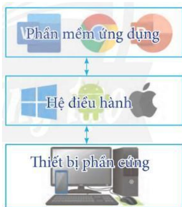
Hình 6. Phần mềm ứng dụng tương tác với thiết bị phần cứng thông qua hệ điều hành
