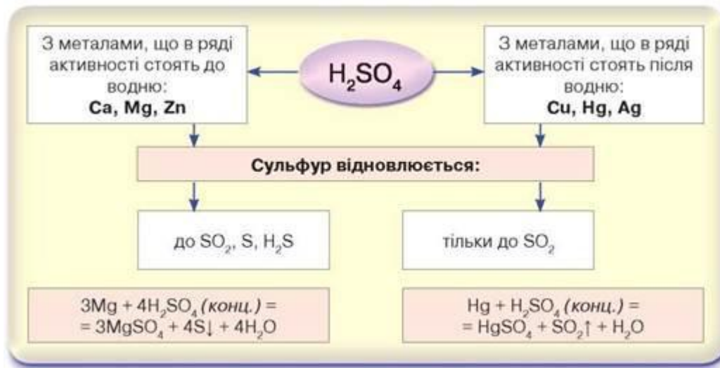
Рис. 41. Схема взаємодії концентрованої сульфатної кислоти з металами
