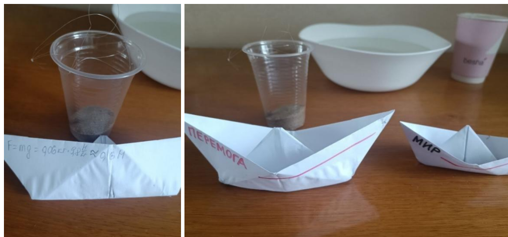
Рис. 6. Нанесені ватерлінії та визначена водотонажність.
