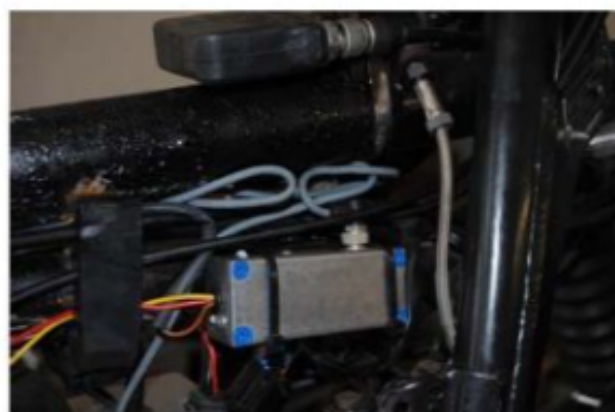
Befestigungsmöglichkeit Steuergerät bei Verwendung von Regler/Gleichrichtereinheit alte Modelle.
