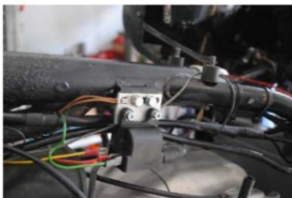
Zündspulenbefestigung bei Modellen mit ehemals 6V Zündspulen hinten. Bei Doppelzündung kann rechts und links je eine Spule befestigt werden.
