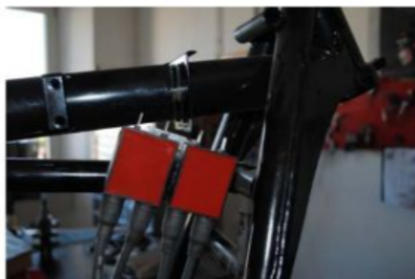
Zündspulenbefestigung für einfach- und Doppelzündung bei neueren R80 und R 100 Modellen.
