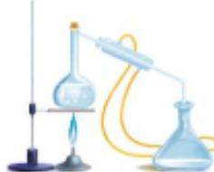
Se calienta la mezcla hasta que se evapore uno de los líquidos. Al enfriarse, se condensa y se recoge de forma líquida.
