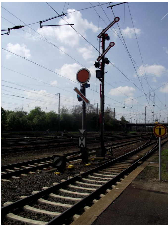
Рис. 8.7 Семафор відкритий, але вимагає проходження зі зменшеною швидкістю (40 км/год)
