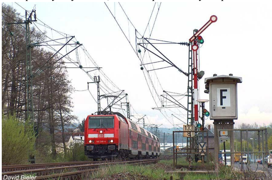
Рис. 8.4 Семафор відкритий, наступний сигнал – відкритий
