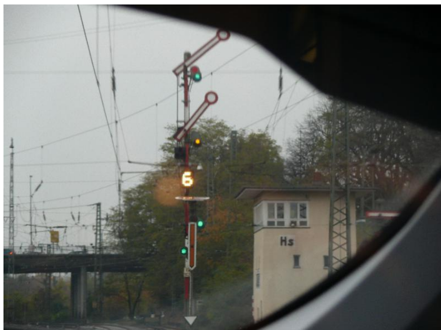
Рис. 8.6 Семафор відкритий, але вимагає проходження зі зменшеною швидкістю
