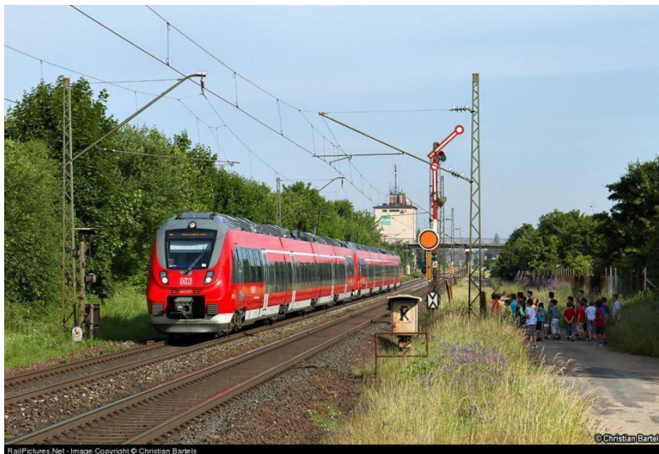
Рис. 8.2 Відкрите положення семафора (наступний сигнал закритий)
