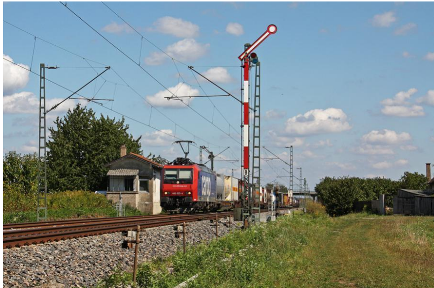
Рис. 8.1. Семафор відкритий. Що з наступним сигналом машиніст дізнається, коли побачить попереджувальний диск або світлофор
