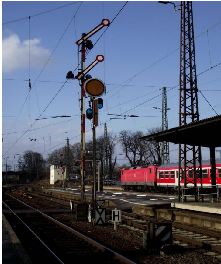
Рис. 8.5. Семафор відкритий, але вимагає проходження зі зменшеною швидкістю (40 км/год)
