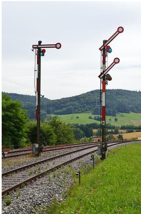
Рис. 8.3 Семафор відкритий, але вимагає проходження зі зменшеною швидкістю (40 км/год)
