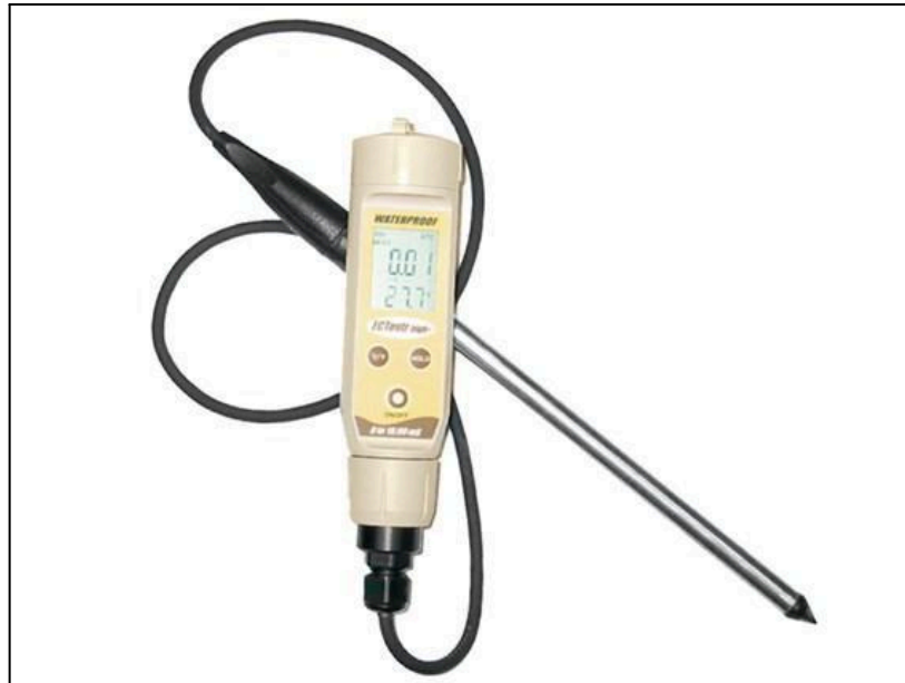
Hình 3. 7: Máy đo độ dẫn điện của đất Spectrum Fieldscout EC 2265FS
