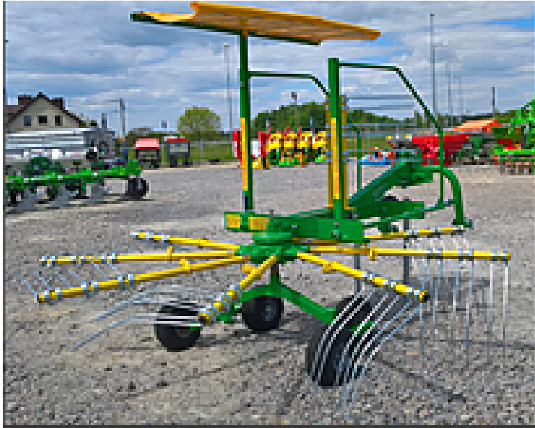
Рис. 13. Роторні граблі ГВ-3,5, ширина захвату - 3,5м (Ставеччина ТЕК, Луцьк)
