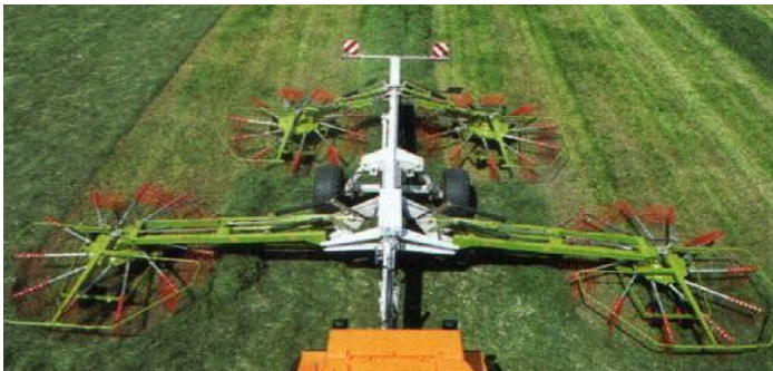
Рис. 11. Чотирьохроторні граблі LINER 3000 CLAAS (Німеччина).
