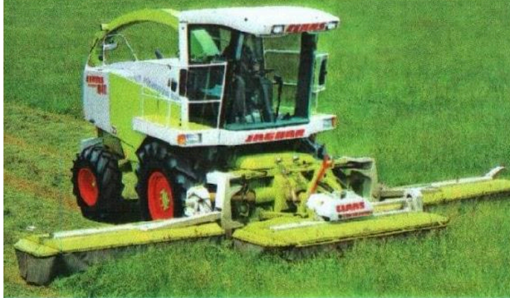
Рис.5. Барабанна косарка KORTO 8100 компанії CLAAS (Німеччина).
