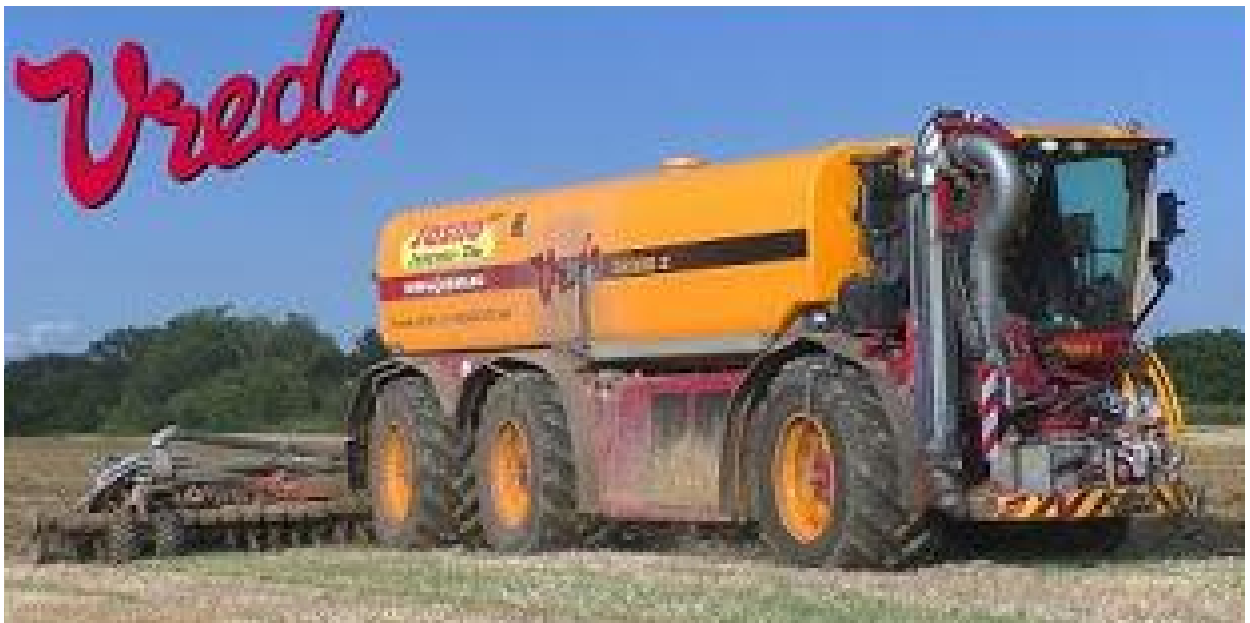
Рис.7 Самохідна машина для внесення гноївки в ґрунт NeW Vredo VT7138 з резервуаром місткістю 32000л.
