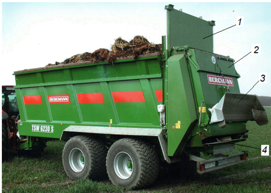
Рис.12. Розкидач органічних добрив BERGMANN (Німеччина): 1 – заслінка; 2 – захисний щиток розкидального пристрою; 3 – захисний щиток розкидального диску; 4 – розкидальний диск
