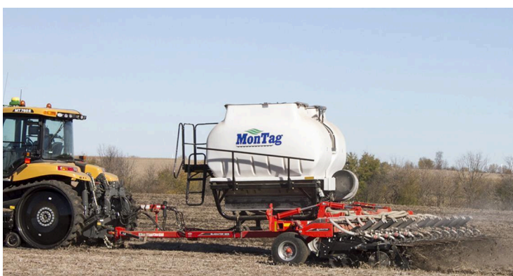
Рис.8. 16-ти рядна ґрунтообробна машина KUHN- KRAUSE GLADIATOR за технологією STRiP-TiLL з пристроєм для
