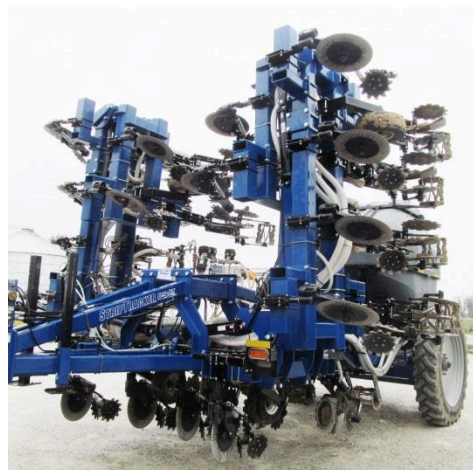
Рис.9. 12-ти рядна ґрунтообробна машина BLU-JET за технологією STRiP-TiLL з пристроєм для внесення мінеральних добрив MonTag.
