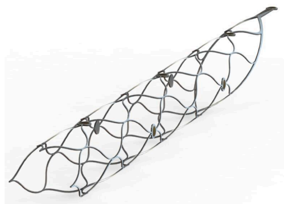
Figura 1. Struttura dello Stentrode. E' possibile osservare lo scaffold automodellante in nitinol sul quale sono montati gli elettrodi in platino. Credits: Nature
