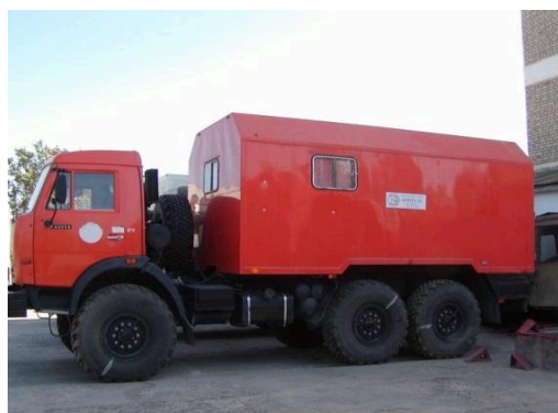
1-rasm. Kamaz 43114 avtomashinasiga o'rnatilgan KOBRA-M karotaj stansiyasining yon va orqa tarafdin ko'rinishi
