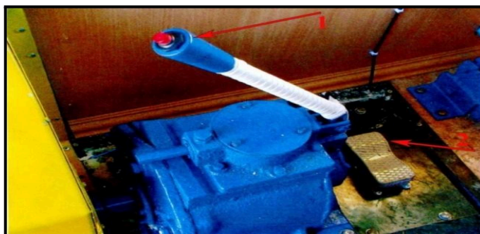
5-rasm. Kamaz avtomashinasiga o‘rnatilgan «Kobra-M» karotaj stansiyasining operator bo‘linmasida joylashgan tezlikni boshqarish mexanizmi 1- richagi; 2- tezlikni ko‘tarish pedali.
