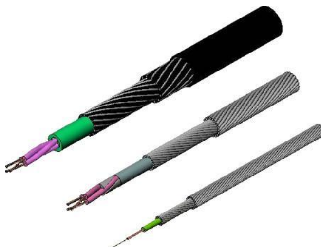
2-rasm. Bitta, uchta yoki ko'p tomirli kabel.
