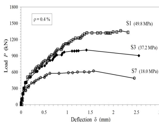
**Gambar 1. Grafik hubungan beban–defleksi slab untuk berbagai mutu beton**
