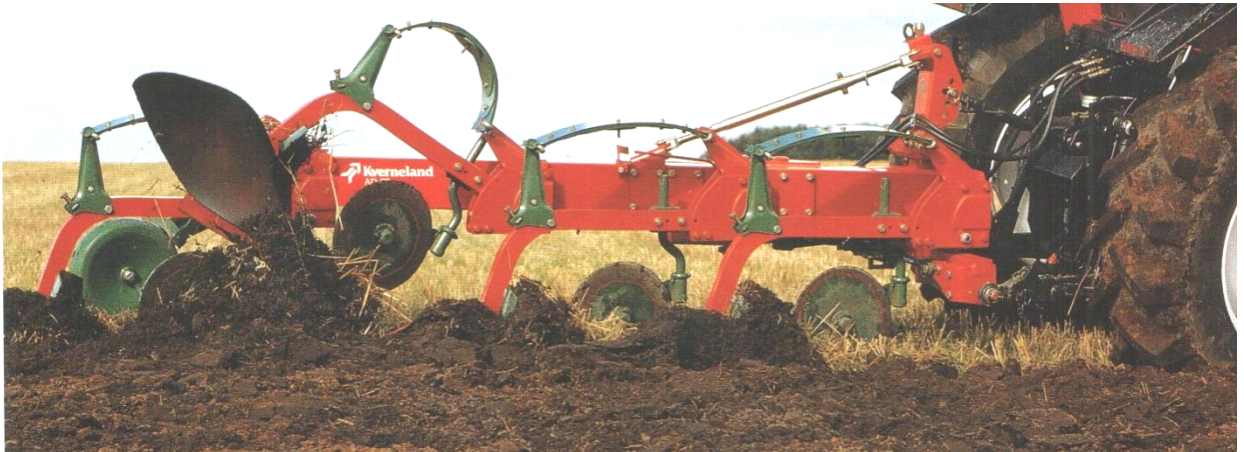
Рис. 10. Система Auto-Reset (автоповернення) компанії KVERNELAND на звичайному плузі
