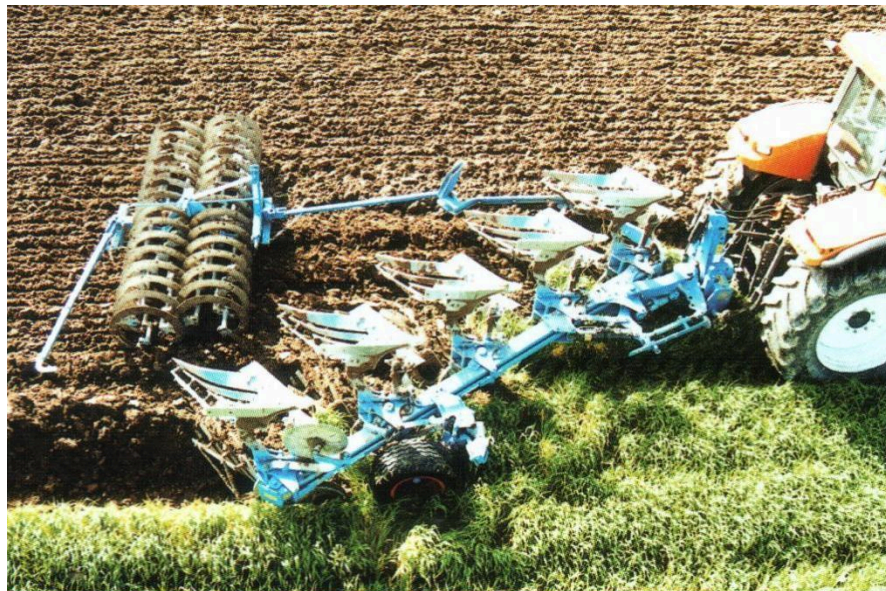
Рис. 18. Оборотний начіпний плуг ВаріОпал (LEMKEN) з двохрядним ущільнювачем ґрунту.
