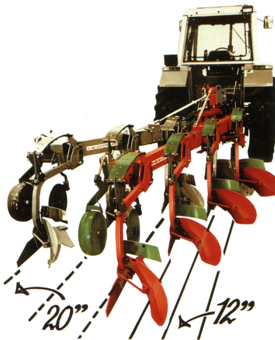
Рис. 9. Регулювання ширини захвату корпусів від 12 до 20 дюймів (30 – 55 см) при допомозі повороту рами плуга відносно трактора.
