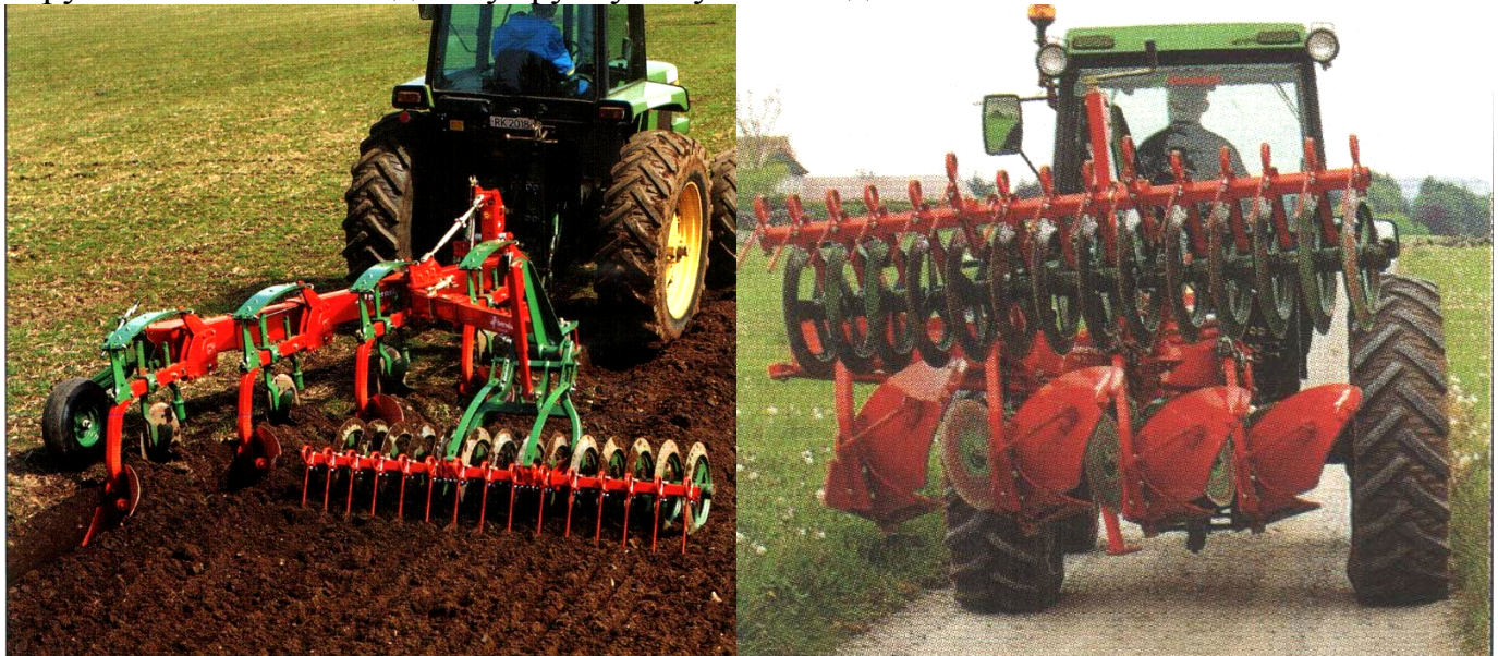
Рис. 13. Плуг з системою „Paktomat” KVERNELAND (Норвегія) в робочому (зліва) та транспортному (справа) положеннях
