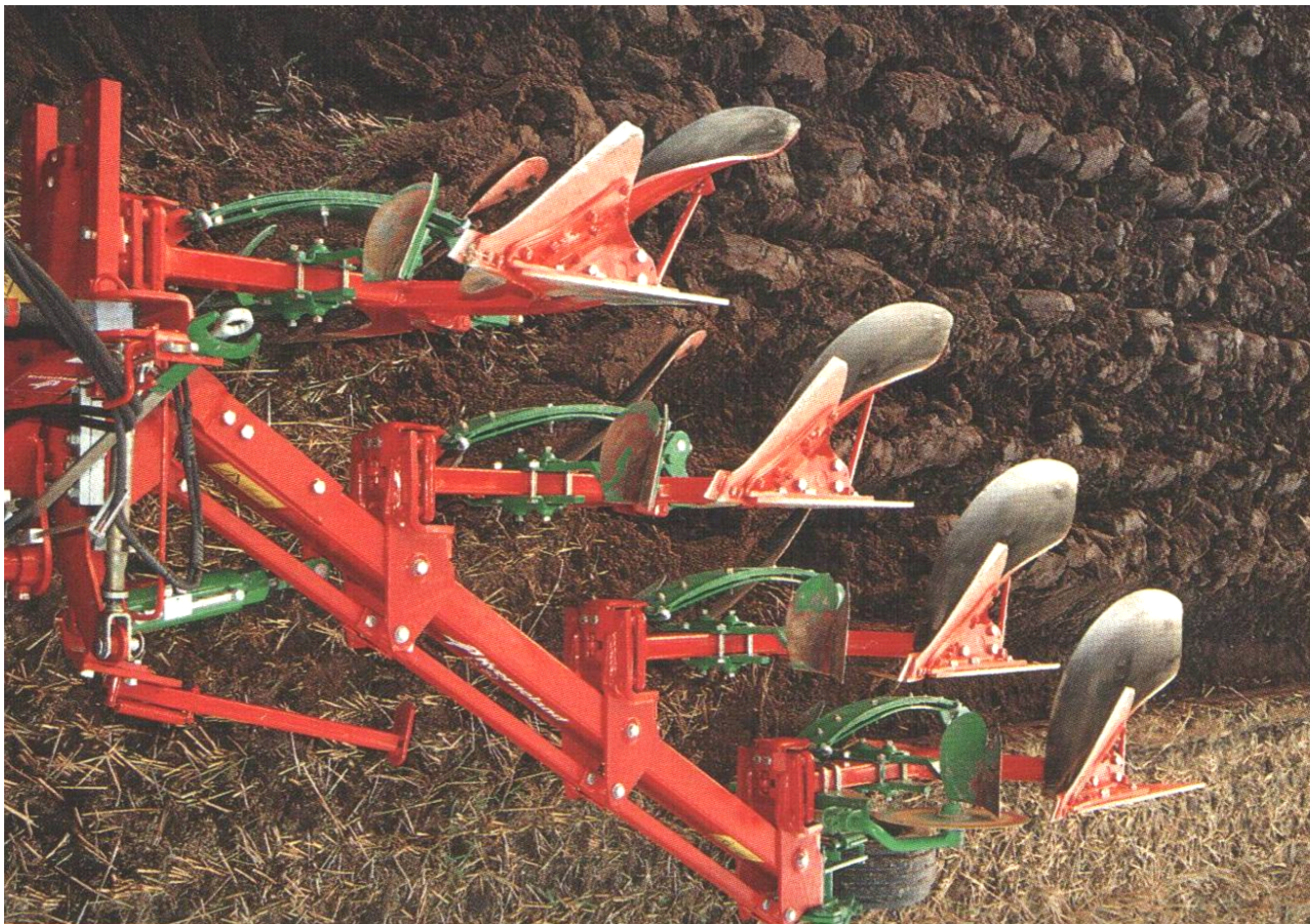
Рис. 11. Система Auto-Reset (автоповернення) компанії KVERNELAND на оборотному плузі
