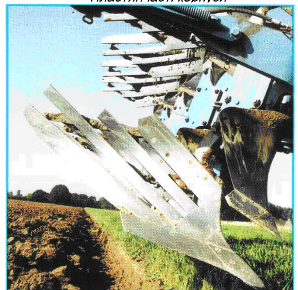
Рис. 15. Типи корпусів плугів LEMKEN
