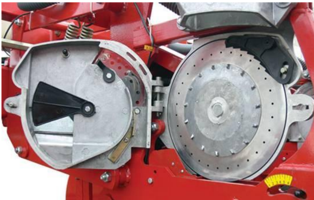
Рис. 14. Висівний апарат сівалки VEGA PROFІ
