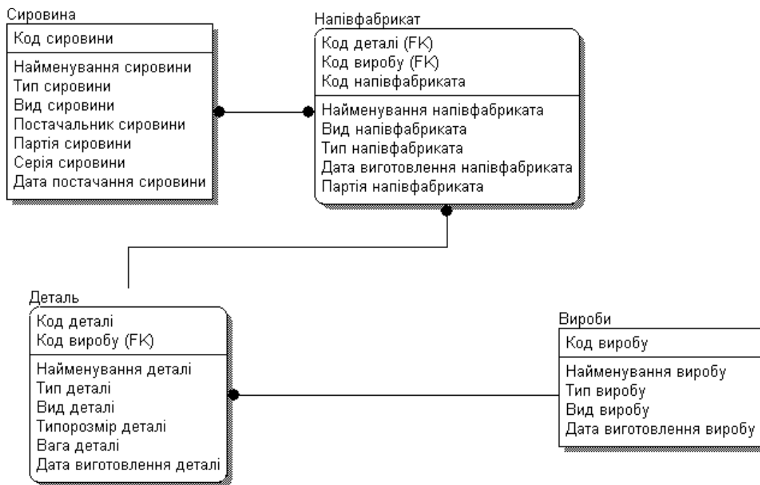
Рисунок 2.8 – Повна логічна модель даних для предметної області «Виготовлення виробів»
