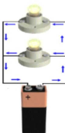
هي دائرة يسري فيها التيار الكهربائي على أكثر من مسار
