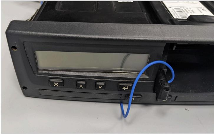
3. Schließen Sie Kabelbaum [HRN-CL01S2 \(C309\)](#) an den Steckverbinder D (**braun**) des Kabelbaums [HRN-URTACHO](#) (eingestellt) oder [HRN-URTACH002-A](#) an.
