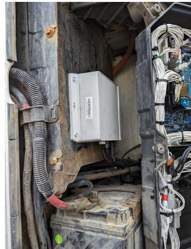
2 Befestigen Sie die IP-Box-Einheit mit den vier im Kit enthaltenen Schrauben.
