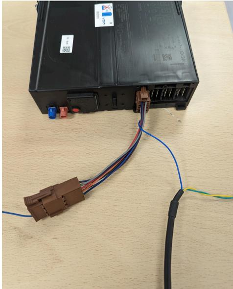
**Fall 3: Brauner Steckverbinder ist mit dem Tachographen-Anschluss D des Tachographen verbunden und Position 8 ist nicht frei**
