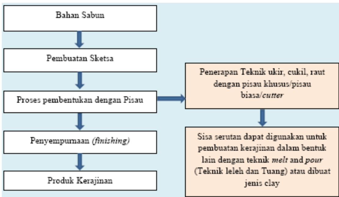
Gambar 1.23 Proses Produksi Pembuatan Kerajinan Sabun dengan Teknik Ukir, Cukil, Raut
