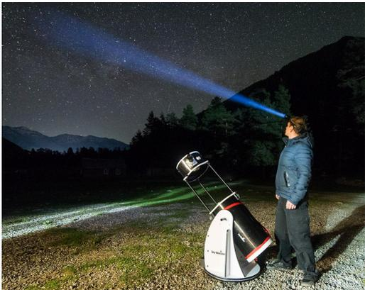
Наш телескоп dob12". Зеркальный телескоп системы Ньютона диаметром 12 дюймов на монтировке Добсона.
