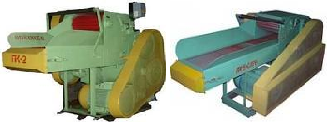
Рис. 5.6. Загальний вигляд подрібнювачів ПК-2 та ПК-5
