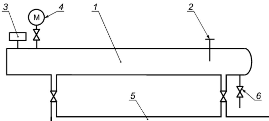
1 - отрезок трубы с заглушкой; 2 - стопор; 3 - сигнализатор прохождения поршней; 4 - манометр; 5 - сливной патрубок с кранами; 6 - контрольный сливной патрубок с краном
