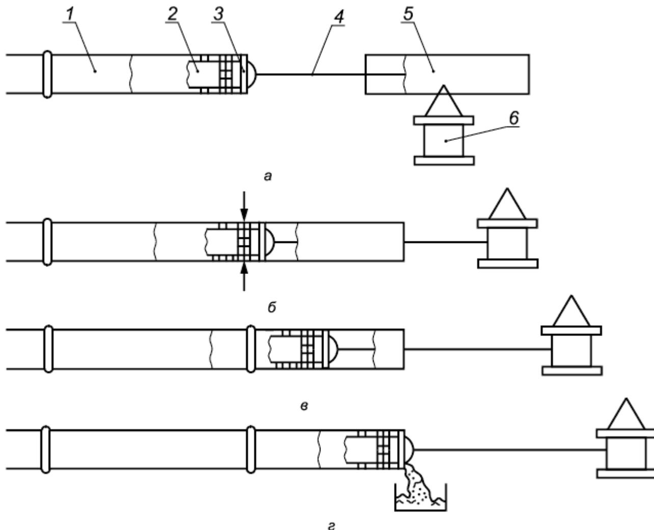
а - пропуск штанги очистного устройства через секцию; б - центровка секций и сварка секций; в - очистка полости собранной секции; г - выброс загрязнений из секций;
