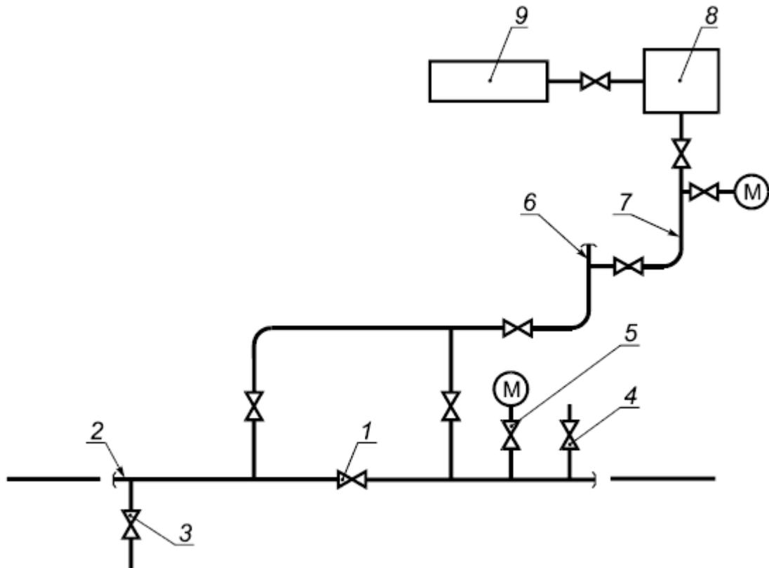
1 - крановый узел запорной арматуры; 2 - патрубок с заглушкой; 3 - сливной патрубок с краном; 4 - воздухопускной патрубок с краном; 5 - манометр; 6 - свеча с заглушкой; 7 - шлейф с арматурой; 8 - опрессовочный агрегат; 9 - передвижная емкость с водой
