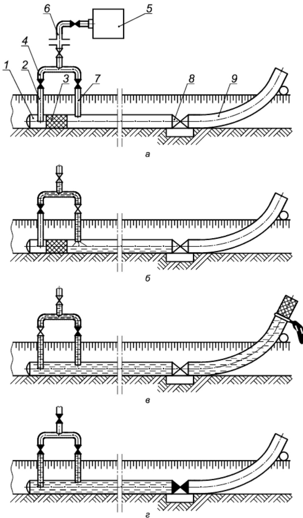
а - подготовка участка к проведению промывки; б - подача воды перед поршнем-разделителем; в - пропуск поршня-разделителя в потоке воды; г - подготовка участка к испытанию;
