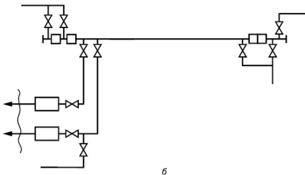
а - заполнение, подъем давления, испытания; б - очистка полости и удаление воды с пропуском поршня под давлением газа;
