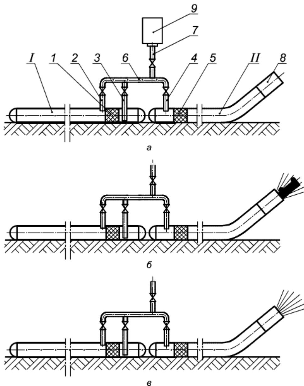
а - заполнение ресивера сжатым воздухом; б - пропуск поршня под давлением воздуха от компрессорных станций; в - продувка плеча II от ресивера без пропуска поршня;
