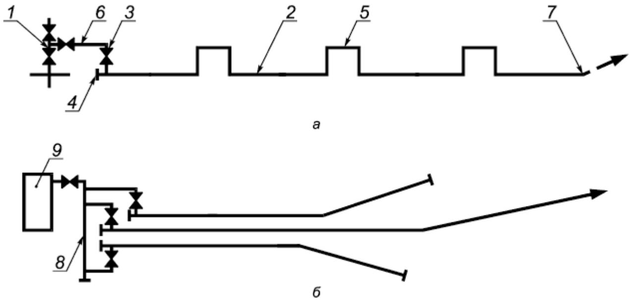
а - продувка природным газом от скважины; б - продувка сжатым воздухом;
