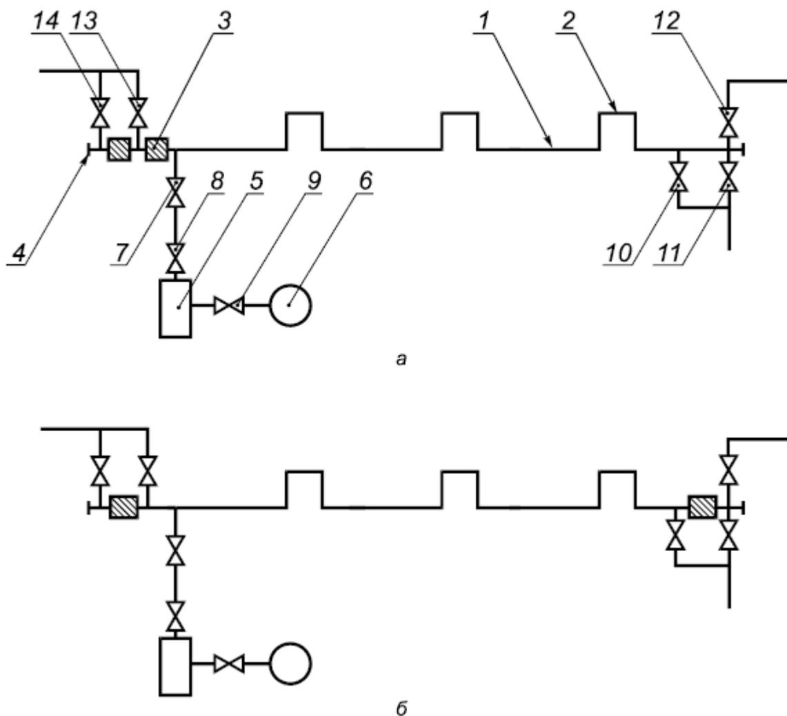
а - заполнение, подъем давления, испытания; б - удаление воды с пропуском поршня под давлением газа;
