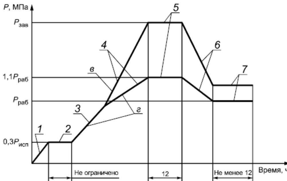
1 - подъем давления от 0 до  $0,3 P_{исп} \leq 2$  МПа; 2 - осмотр трубопровода; 3, 4 - подъем давления до испытательного ( $e$  - газ;  $v$  - вода); 5 - испытания на прочность (в нижней точке  $P_{исп} = P_{\sigma 0,2}$ ; в верхней точке  $P_{исп} = 1,1 P_{раб}$ ); 6 - снижение давления; 7 - проверка на герметичность
