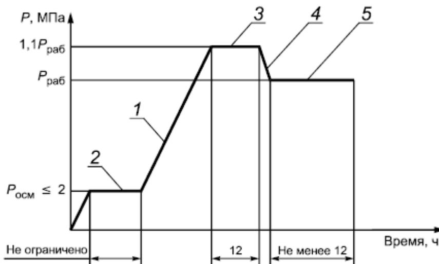
1 - подъем давления; 2 - осмотр трубопровода; 3 - испытания на прочность; 4 - сброс давления; 5 - проверка на герметичность ( $P_{осм}$  - давление, при котором производится осмотр трассы)
