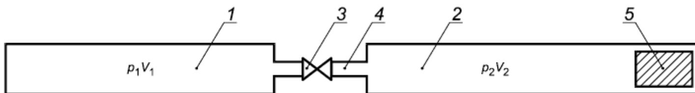
1 - ресивер; 2 - трубопровод; 3 - кран; 4 - перемычка; 5 - поршень;
