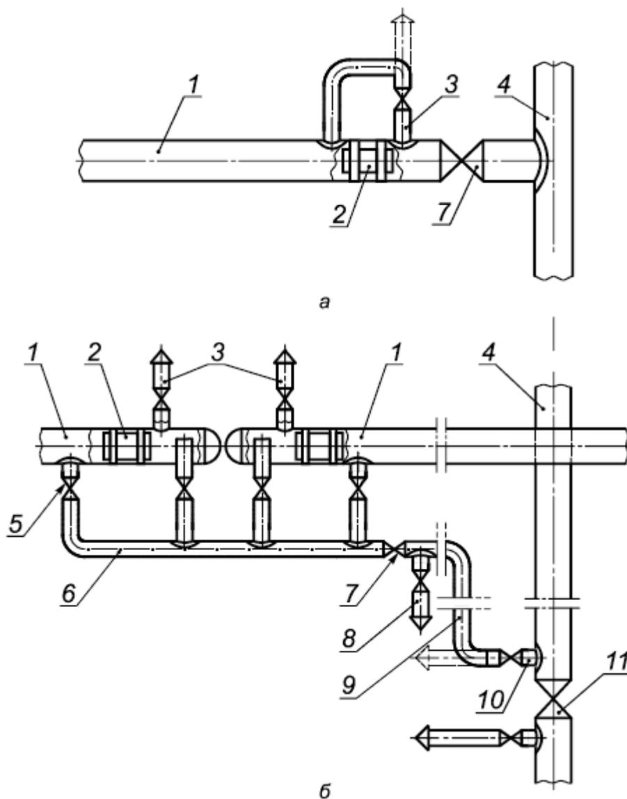
а - непосредственно на месте проектной вырезки газопровода - отвода в действующий газопровод; б - через свечу действующего газопровода и временный шлейф, подведенный к продуваемому участку;
