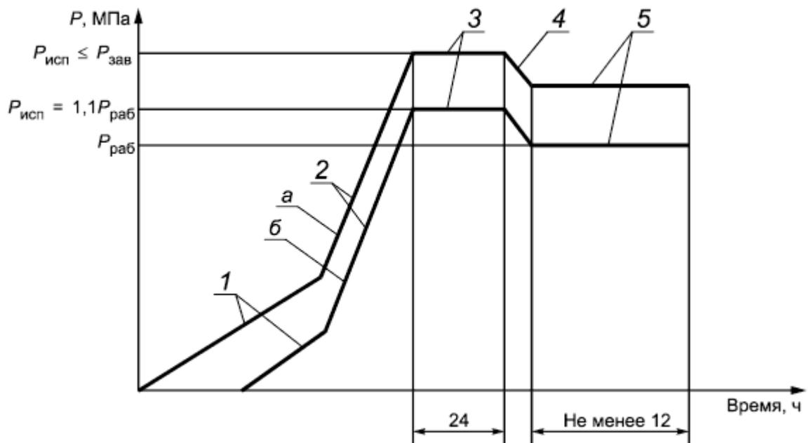
*a* - в нижней точке трубопровода; *б* - в верхней точке трубопровода;
