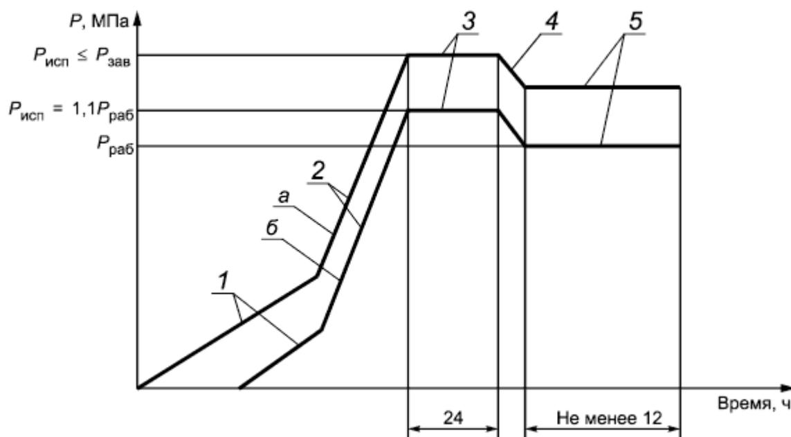
а - в нижней точке трубопровода; б - в верхней точке трубопровода;
