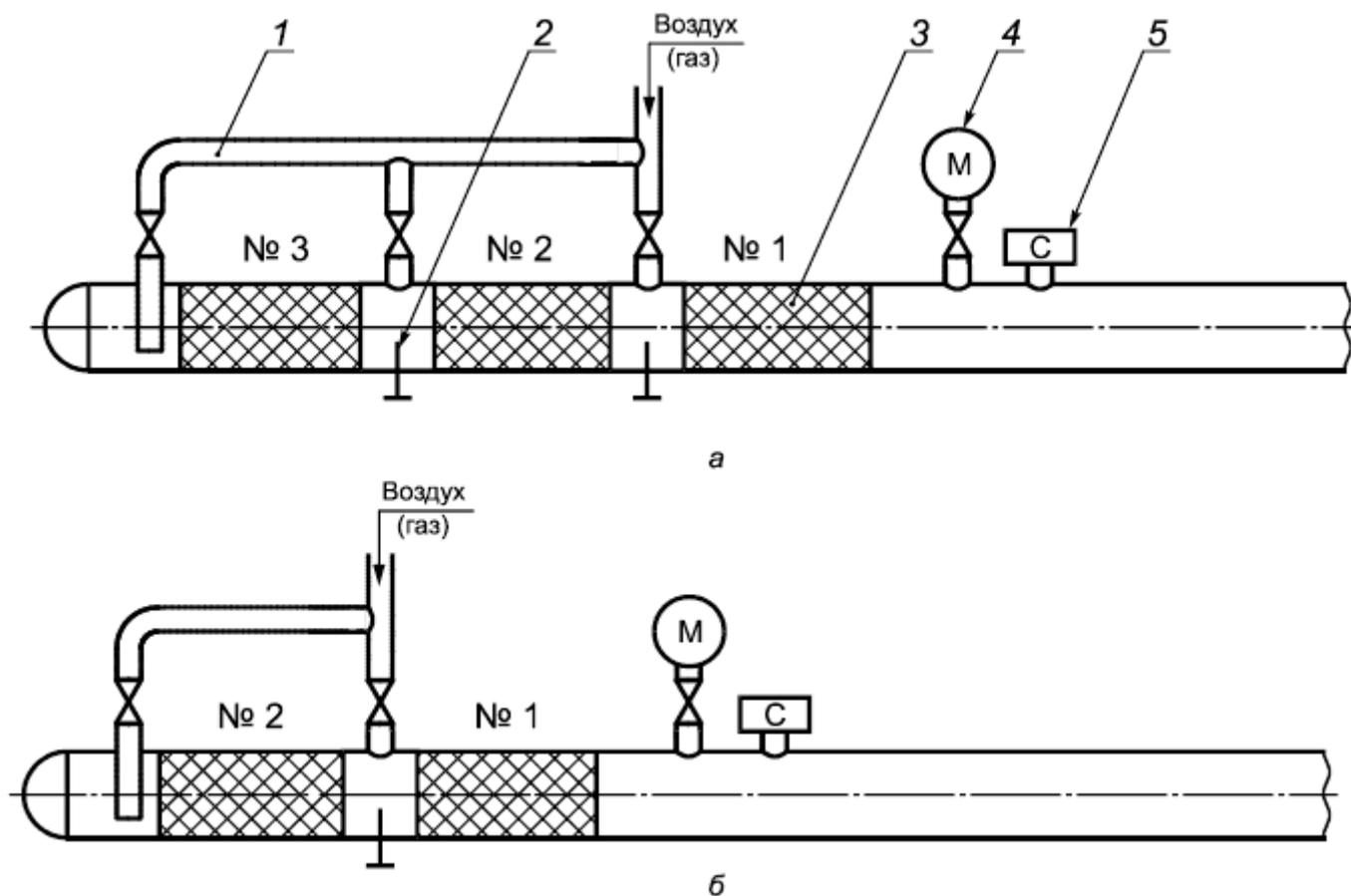
а - камера пуска на три поршня; б - камера пуска на два поршня;
