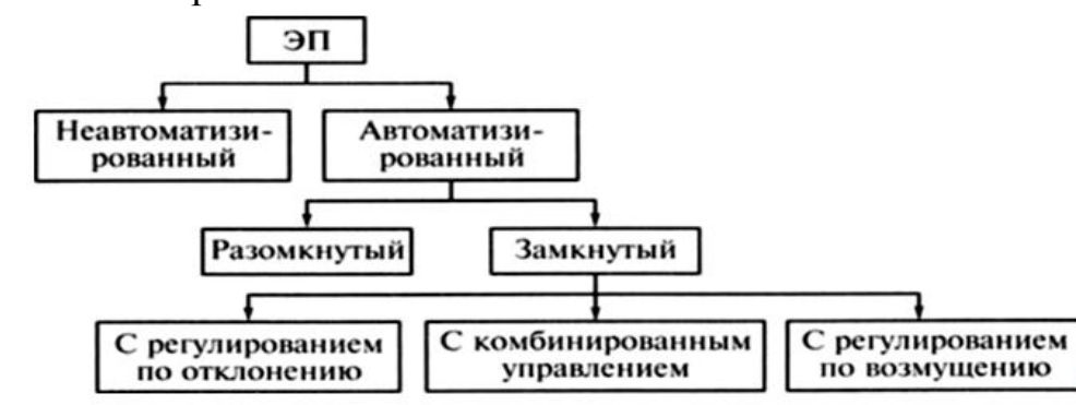
Рисунок 2 - Классификация электроприводов по степени их автоматизации рабочих машин и механизмов и качеству выполняемых операций
