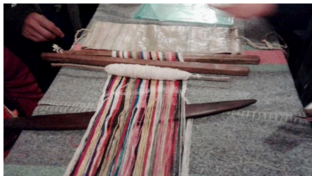
ภาพที่ 41 ส่วนประกอบของเต้า ได้แก่ ไม้คู้ ไม้ไผ่ ผีเสื้อ(มีด) ฮาราชิน(ที่กรอด้าย) เกอะ(ข้างมีด)
