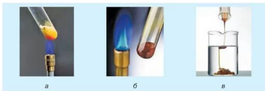
Рис. 34. Процес перетворення кристалічної сірки на пластичну
