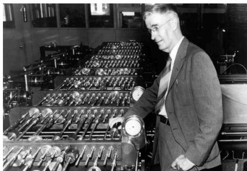
Estamos viendo a Vannevar Bush y su Analizador Diferencial creado en 1930. Esta máquina pasa a la historia por ser quizás la primera que combina las piezas mecánicas con componentes electrónicos. Las piezas electrónicas que usó son los relés y tubos de vacío. Éstos últimos sobre todo fueron tan importantes y se usaron tanto durante el desarrollo de las primeras computadoras, que es necesario detenernos unos minutos en ellos.
