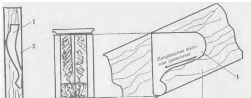
Рис. 201. Лекала для разметки профилей криволинейных деталей: а — разметка по лекалу; б — кронштейн; в — пример указания направления волокон древесины на лекале;
