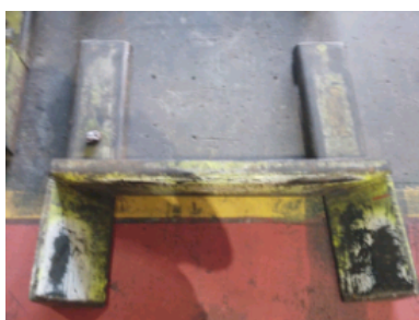
Trava rodas utilizado no carregamento de frota fixa
