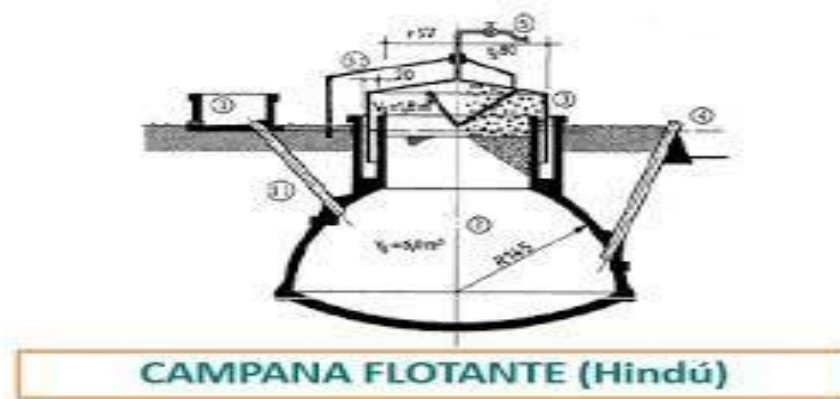
Figura 1. Esquema de una planta de campana flotante tipo hindú. (Arboleda Olaya & González Salcedo, 2009)
