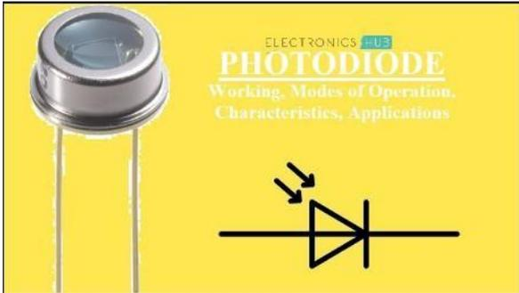
Dioda Foto merupakan jenis dioda yang memiliki fungsi untuk mengubah energi cahaya menjadi arus listrik melalui kedua elektroda-nya Dioda jenis ini banyak digunakan sebagai sensor mendeteksi cahaya, yaitu seperti:
