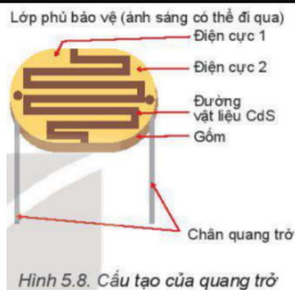
Hình 5.8. Cấu tạo của quang trở
