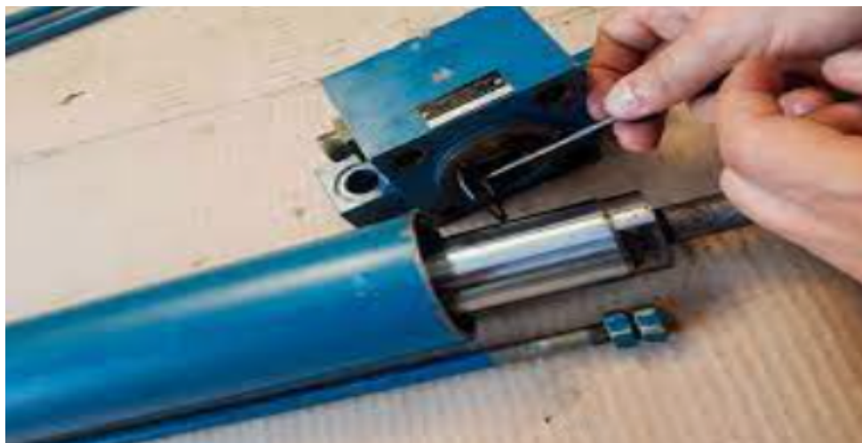
Figura 31 - Manutenção Preventiva de cilindros "EUROMAV,2021"
