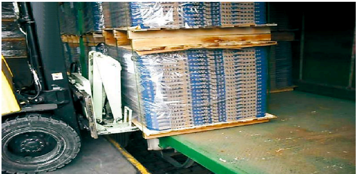
Figura 35 - Alto risco de acidente - Vão entre carretas e pisos de armazéns
