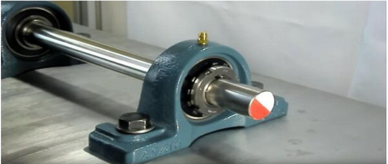
Figura 8 - Eixo Bi apoiado com dois mancais e rolamento que farão o movimento angular da rampa.
