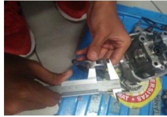
Gambar 5. Pengukuran Rocker Arm Menggunakan Jangka Sorong
