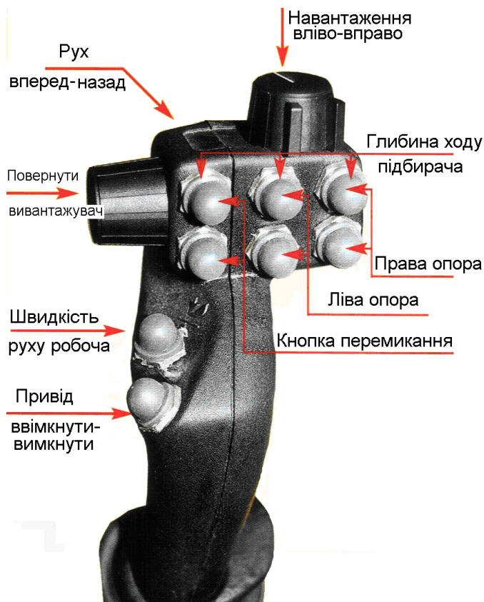
Рис. 12. Правий джойстик буряконавантажувача ROPA MAUS та функції, які він виконує
