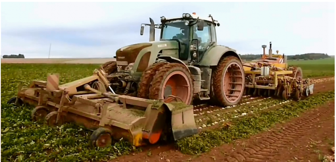
Рис. 16. 12-тирядний агрегат для зрізування гички та викопування коренеплодів у валок (SOYEZ, Франція).
