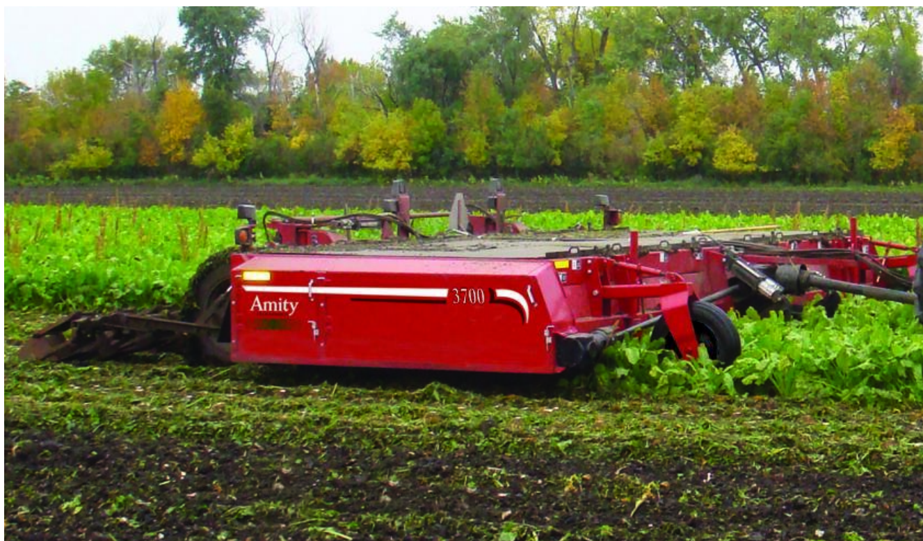
Рис. 13. 12-тирядна гичкозбиральна машина WIC 3750 (AMITY TECHNOLOGY, США)
