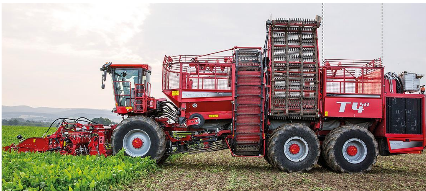
Рис.4. Шестирядний самохідний комбайн н HOLMER TERRA DOS T4/40
