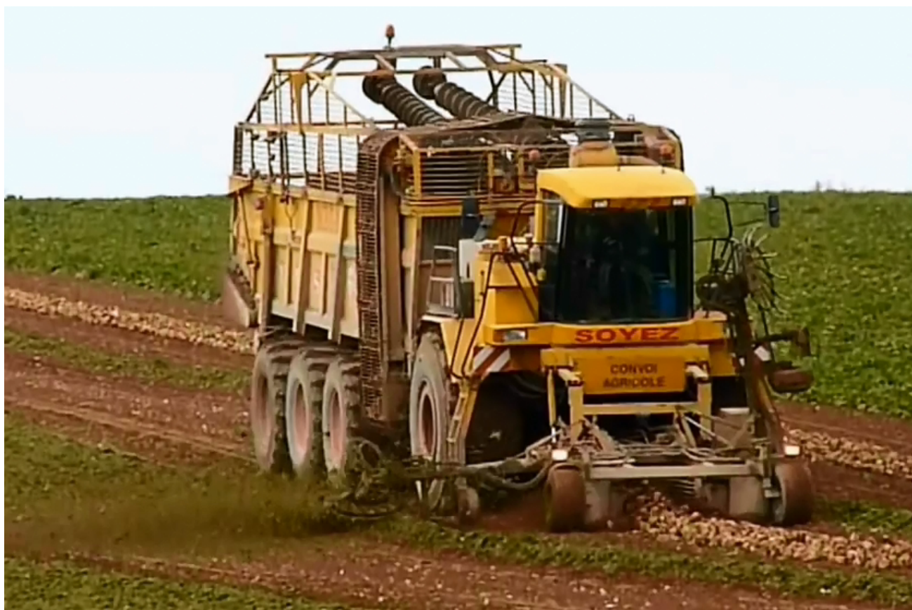
Рис. 17. Машина Mega Star DB75 для підбирання, очищення і навантаження коренеплодів в бункер (SOYEZ, Франція).
