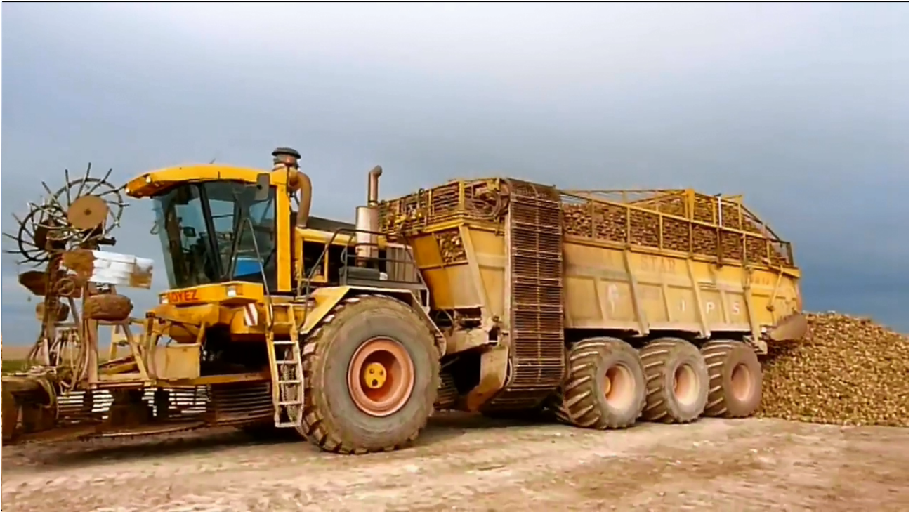
Рис. 18. Вивантаження коренеплодів Mega Star DB75 (SOYEZ, Франція).
