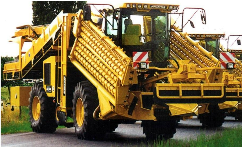
Рис. 11. Буряконавантажувач ROPA MAUS (Німеччина) в транспортному положенні.
