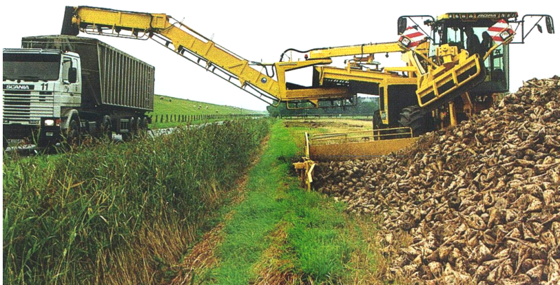
Рис. 10. Буряконавантажувач ROPA MAUS (Німеччина) в робочому положенні.
