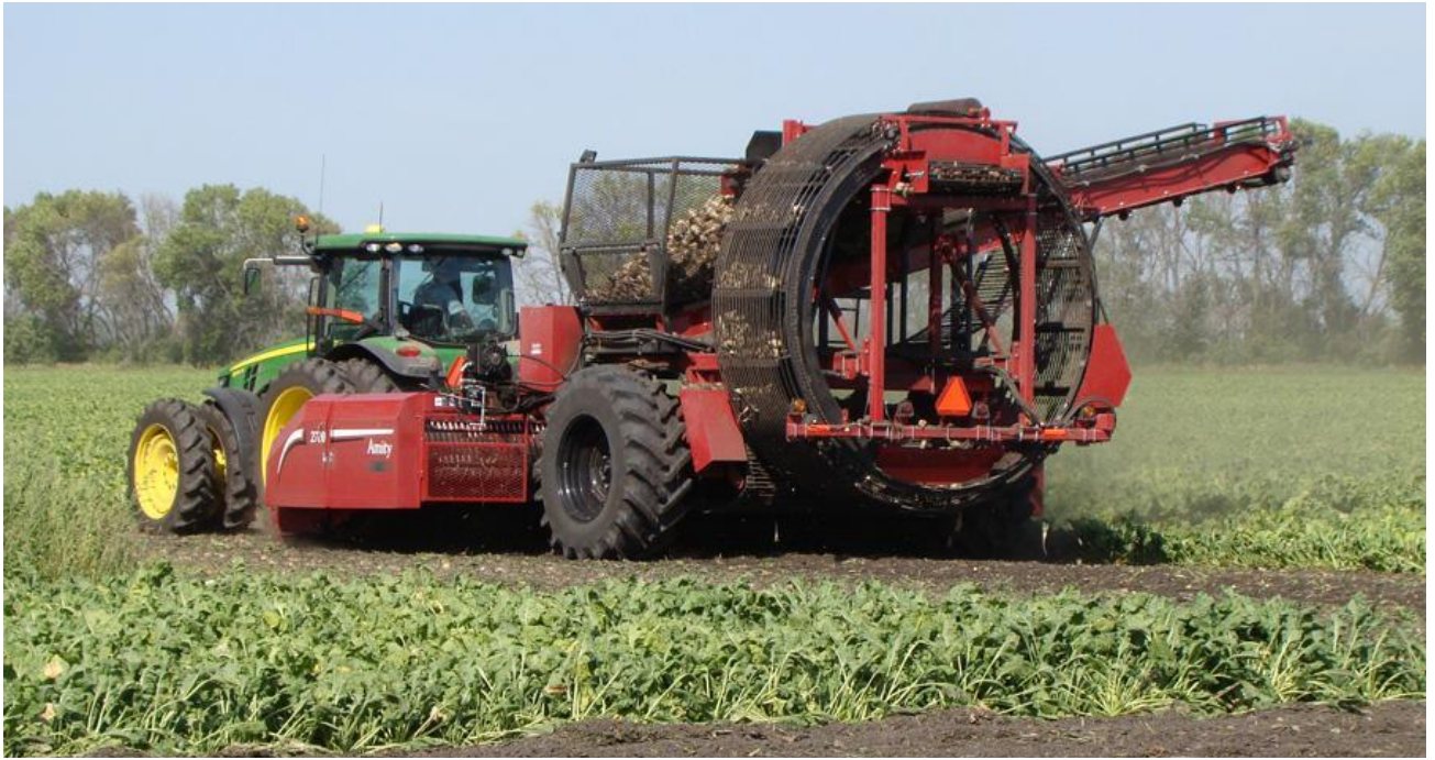
Рис 15. 12-ти рядна коренезбиральна машина WIC 2700 з барабанним завантажувальним транспортером (AMITY TECHNOLOGY, США)
