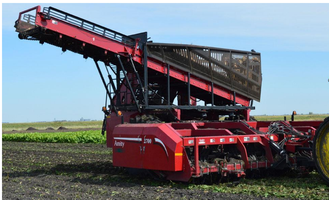
Рис 14. 12-ти рядна коренезбиральна машина WIC 2700 з прутковим завантажувальним транспортером (AMITY TECHNOLOGY, США)
