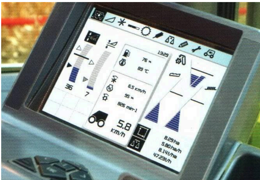
Рис. 9. Монітор бортового комп'ютера CEBIS комбайна LEXION
