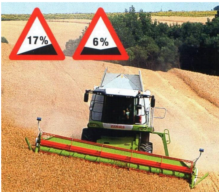
Рис. 7. Система керування положенням молотарки MULTI CONTOUR для встановлення молотарки в горизонтальне положення при роботі на схилах.
