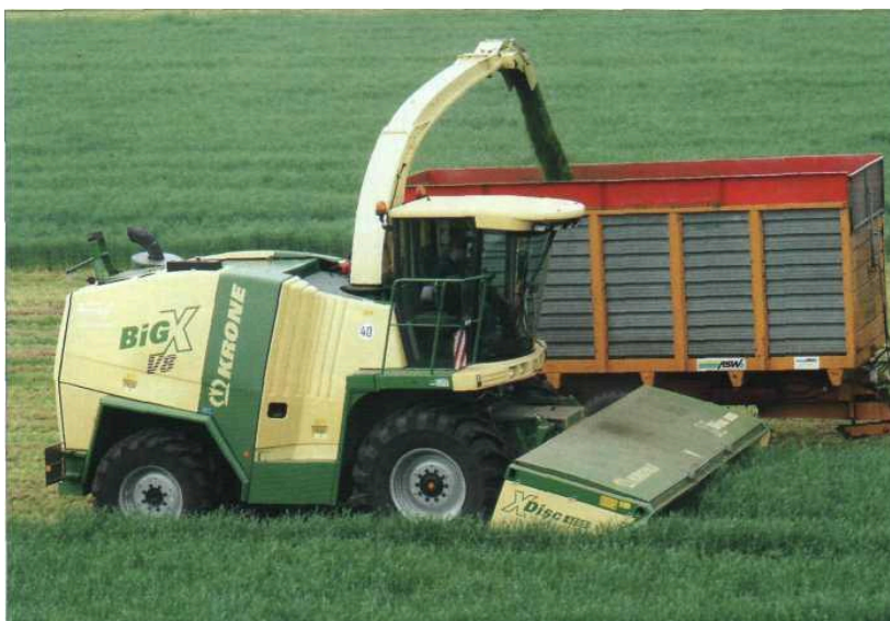
Рис. 18. Кормозбиральний комбайн BIG X (KRONE) з жаткою для збирання трав.
