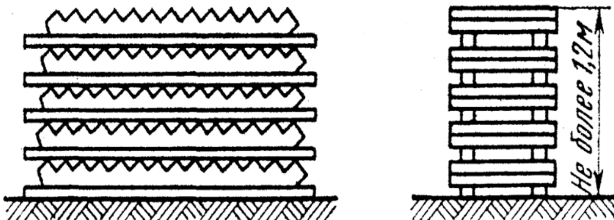
Рис. 123. Складирование сборных конструкций: а) лестничных маршей; б) фундаментных блоков.
