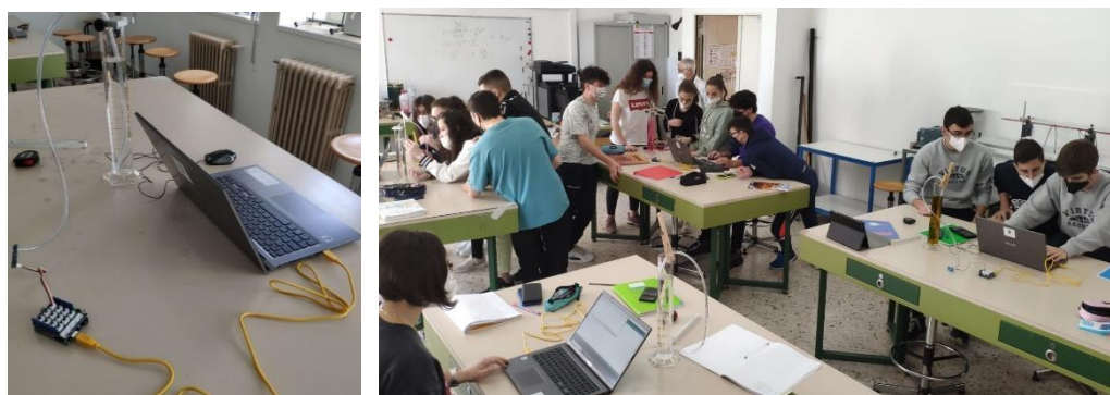
Figura 1 – A sinistra, il sistema GROVE di Arduino con il sensore di pressione per la verifica della legge di Stevino. A destra gli studenti impegnati nell'esperienza della verifica della legge di Stevino, con liquidi diversi, con Arduino.
