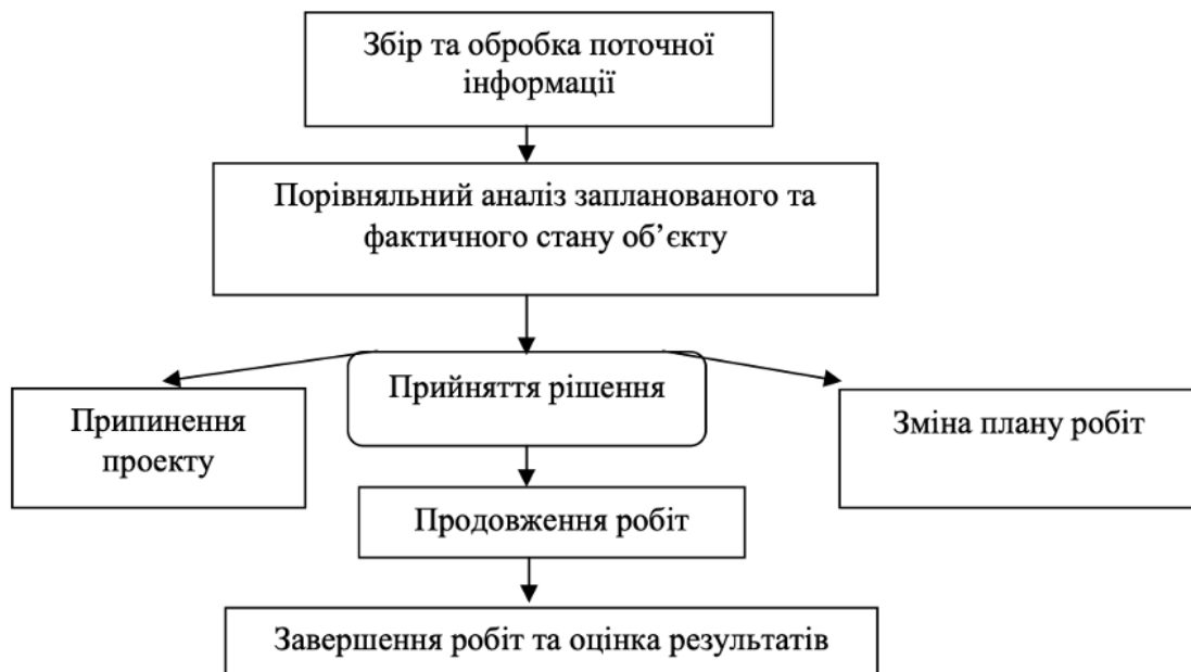
Рис 15. 2 Схема контролю та управління проектами
